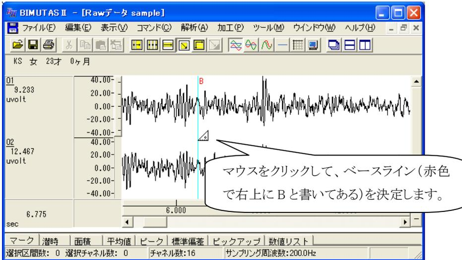
波形上で、計測範囲の終端(2番目の左クリック)を決定します。計測範囲の終端は連続して変更することができ、クリックする度にデータがタブに表示されます。
