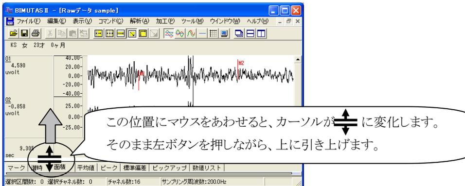
波形の下にあるタブ領域が表示され、①で操作したデータが表示されていることがわかります。
