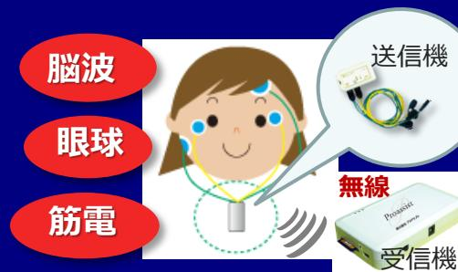
脳波センサ (プロアシスト社製) を利用することで、手軽に睡眠脳波の計測が行えます。計測は、ディスプレイ電極を貼って電源を入れるだけ。小型・軽量で、無線を利用しているため被験者を拘束しません。自宅でも簡単にデータ計測が行えます。
