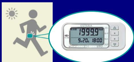
活動量計とは高機能な万歩計です。3軸の加速度センサーが搭載されており、歩数や運動量などの他に、体の動きに応じた「活動量」を計測しています。
